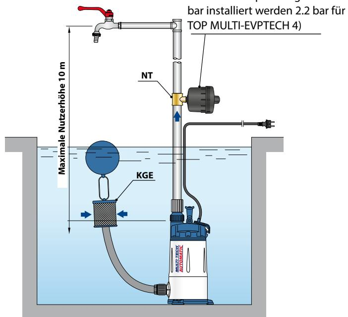
Um häufige Neustarts und eine größere Energieeinsparung zu erzielen, sollte der Behälter 1 SF mit einer Vorspannung von 1.2 bar installiert werden 2.2 bar für TOP MULTI-EVOTECH 4)
