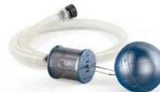
Mit dem Kit KGE erfolgt die Ansaugung des TOP MULTI-EVOTECH ca. 10 cm unter der Wasseroberfläche, wodurch die Ansaugung von Schwimmresten oder Sedimenten, die sich am Boden des Tanks ablagern, verhindert wird und somit die Elektropumpe nicht beschädigt wird.
